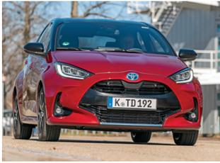
**Antrieb** 1.490 cm<sup>3</sup>; 3 Zylinder; stufenlose Automatik, Frontantrieb
