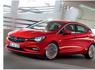
**Antrieb** 1.598 cm<sup>3</sup>; 4 Zylinder; 6-Gang-Schaltung, Frontantrieb
